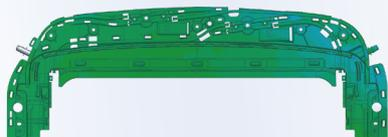
Данные, полученные в режиме 26 лазерных линий.
